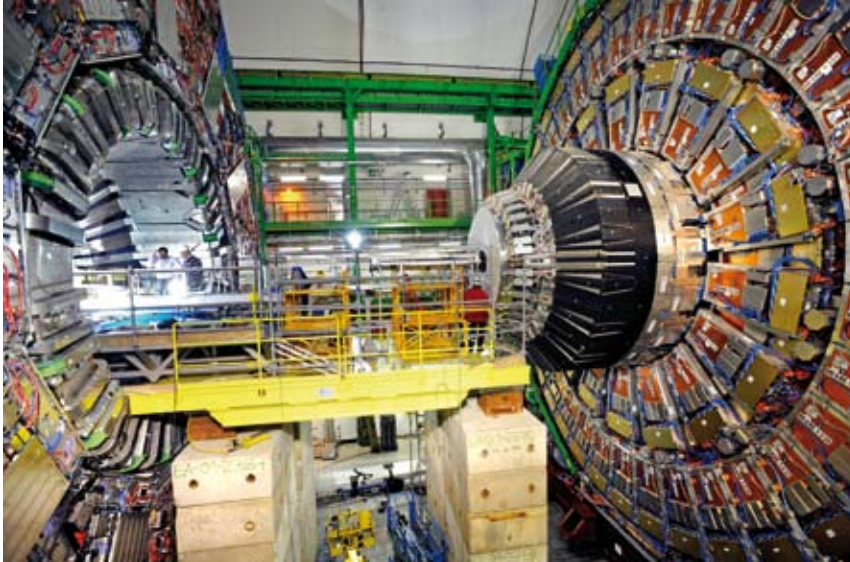
CERN-personeel werkt aan de bundelpijp in de CMS-detector (links)
